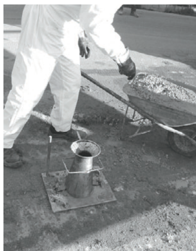
Figura 2.9. Esempio di riempimento del cono di Abrams in cantiere (fonte: Istituto di Ricerca e Sperimentazione Sidercem S.r.l.)
