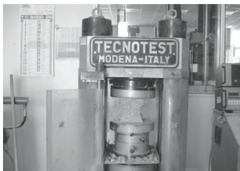
Figura 3.27. Rottura di provino cubico di calcestruzzo sottoposto a compressione assiale (fonte: Istituto di Ricerca e Sperimentazione Sidercem S.r.l.)
