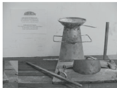
Figura 2.6. Cono di Abrams (fonte: Istituto di Ricerca e Sperimentazione Sidercem S.r.l.)
