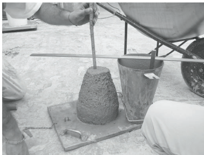
Figura 2.11. Fase di misurazione dell'abbassamento al cono del calcestruzzo in cantiere (fonte: Istituto di Ricerca e Sperimentazione Sidercem S.r.l.)
