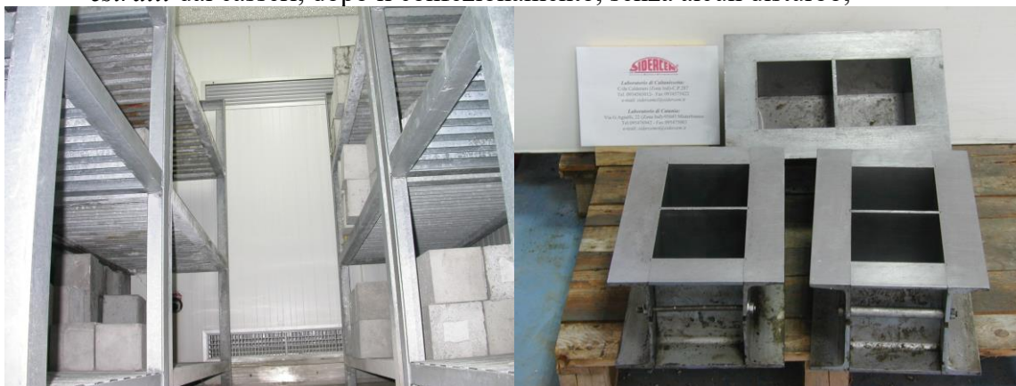
Figura 1a - 1b - Camera umida (UNI EN 12390-2), casseri cubici (UNI EN 12390-1)
