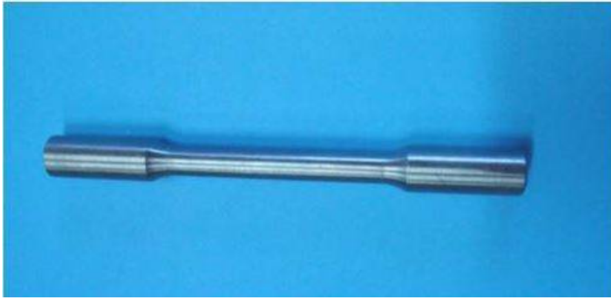
Figura 1 – Provino, sagomato da sottoporre direttamente a prova dopo la verifica delle tolleranze (Crediti: V.D. Venturi)
