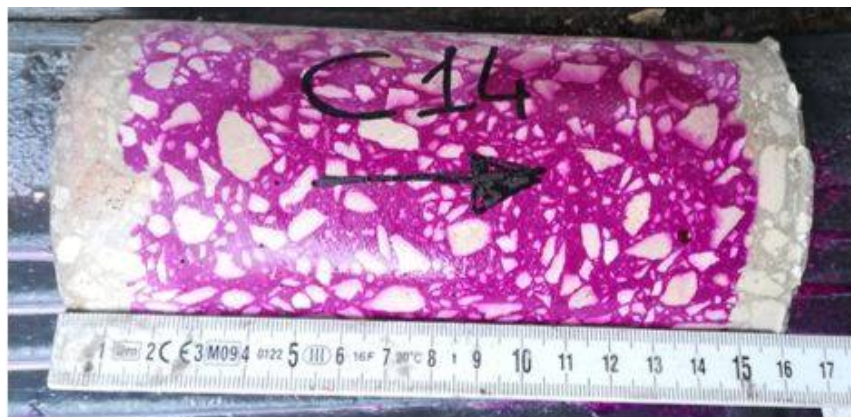
Figura 2 – Campione, carota da ridurre alle dimensioni convenzionali mediante taglio e rettifica (Crediti: V.D. Venturi)
