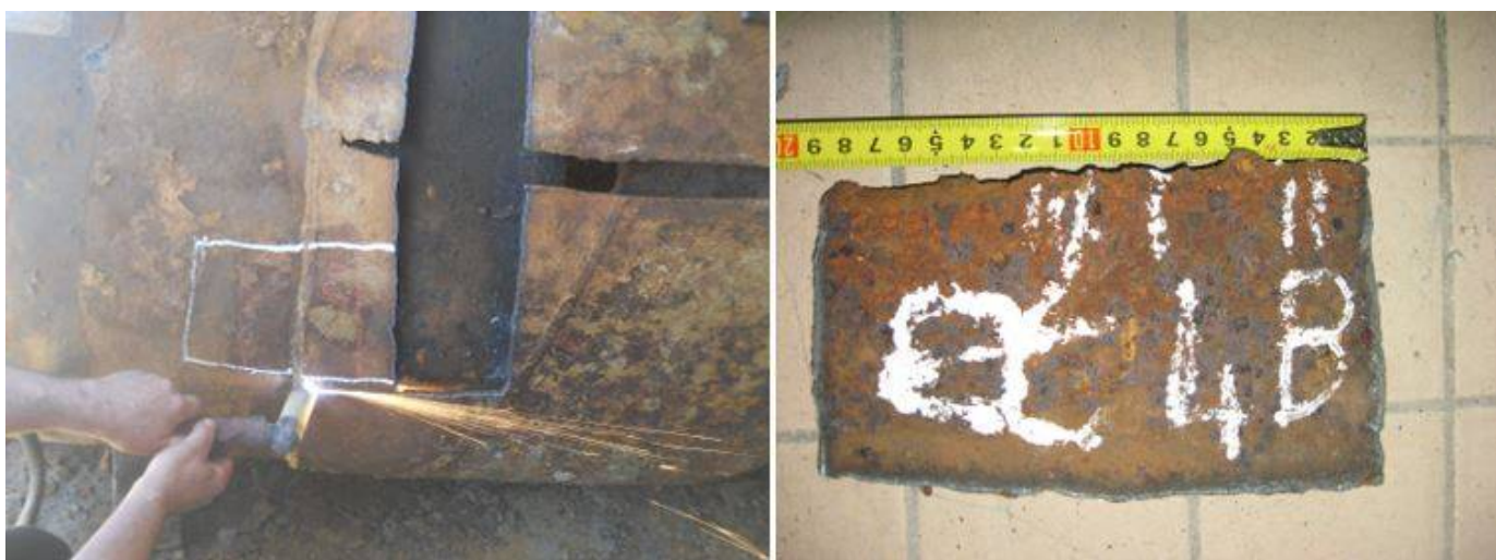
Figura 4 – Estrazione con taglio al plasma di saggio dal quale ricavare i provini necessari (Crediti: V.D. Venturi)
