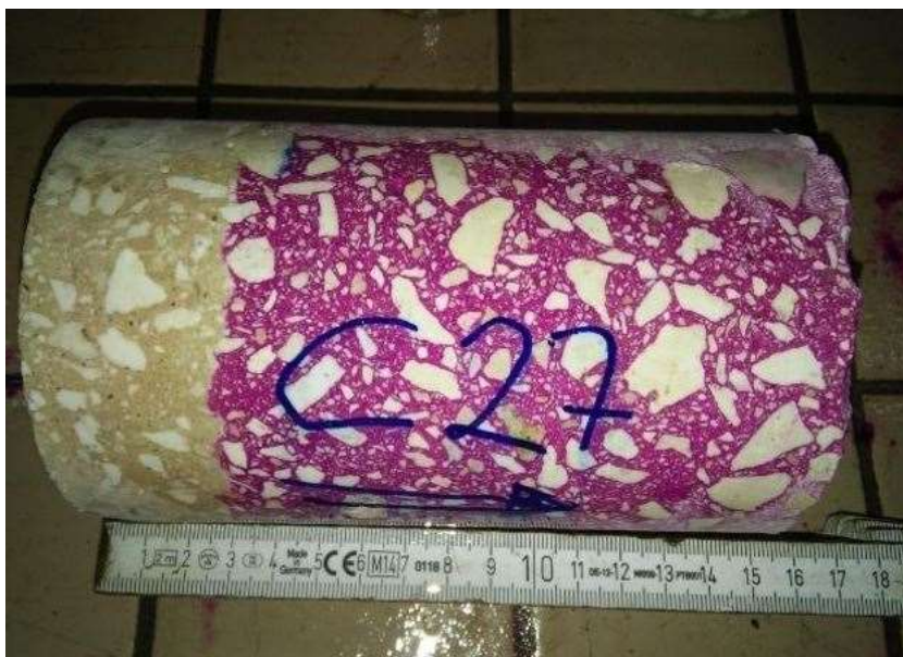
Foto 4 – La profondità di carbonatazione, metodo della fenoltaleina. (foto concessa da Sidercem s.r.l. Istituto di Ricerca e Sperimentazione)
