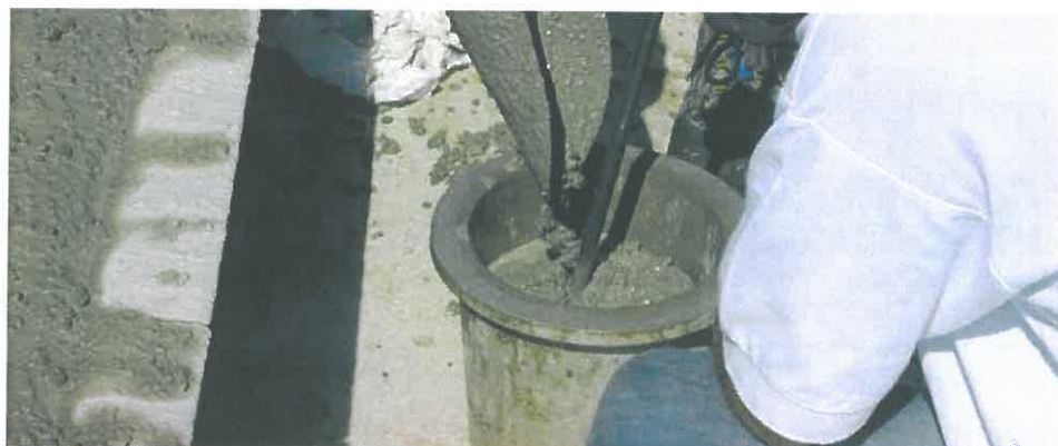
Fig. 2 Prelievo calcestruzzo, con carriola.
