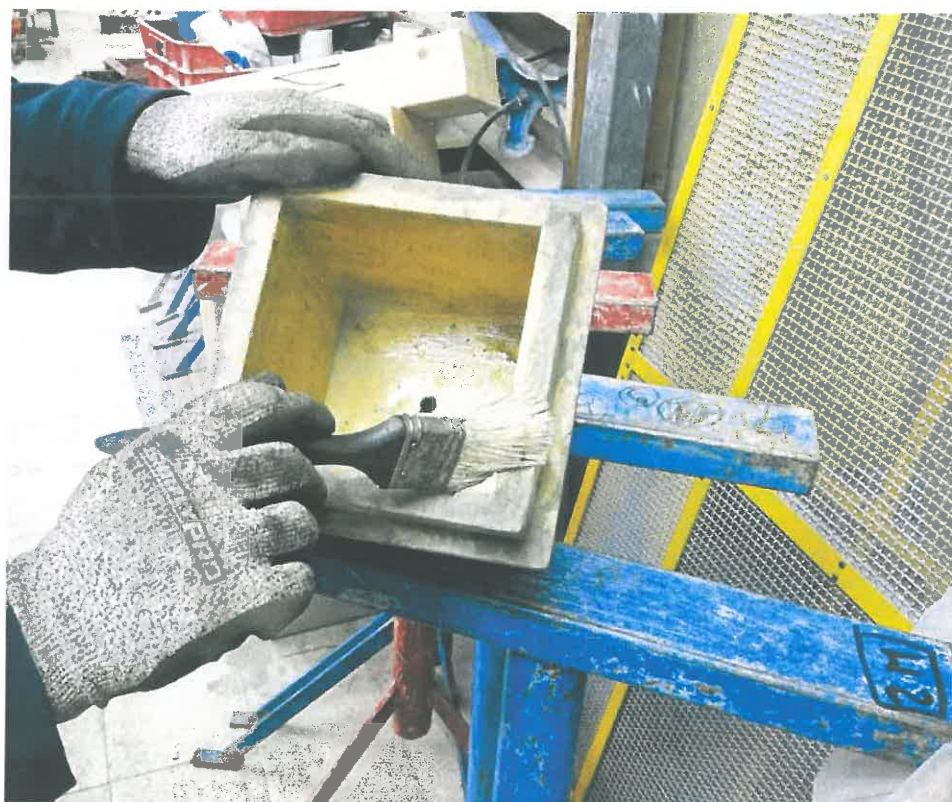
Fig. 6 Applicazione della pellicola antievaporante su provini di cubici calcestruzzo.
