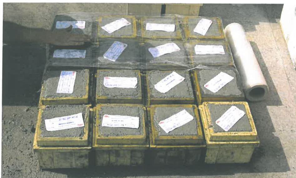
Fig. 6 Applicazione della pellicola antievaporante su provini di cubici calcestruzzo.
