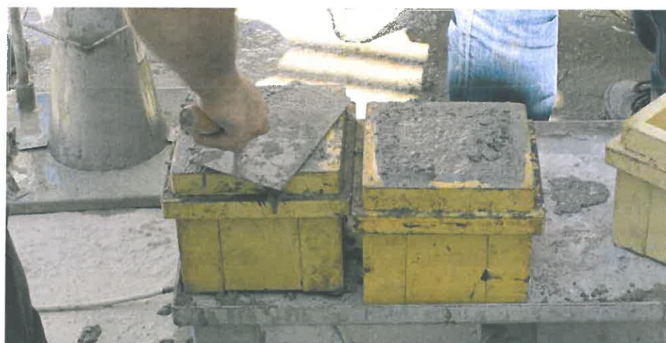
Fig. 5 Confezionamento di provini cubici di calcestruzzo.
