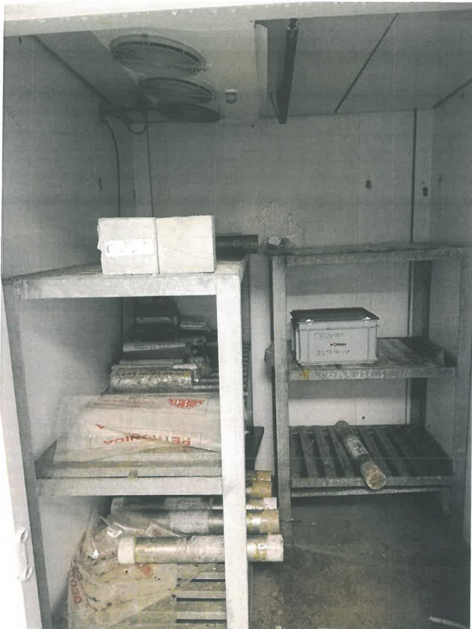
Fig. 13 Stagionatura del calcestruzzo in camera umida.
