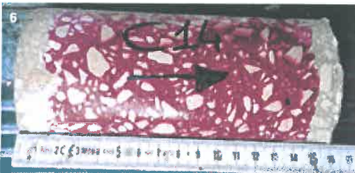
6. Campione, carota da ridurre alle dimensioni convenzionali mediante taglio e rettifica
