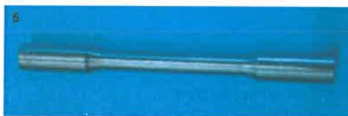
5. Provino, sagomato da sottoporre direttamente a prova dopo la verifica delle tolleranze
