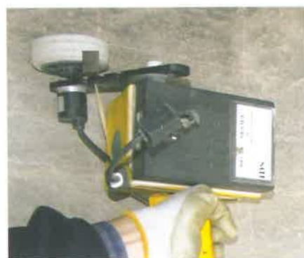
Figura 10 - Radar geologico IDS RIS: trasduttore e sistema di acquisizione (sx); antenna da 1.6 GHz (dx)
