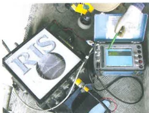
Figura 10 - Radar geologico IDS RIS: trasduttore e sistema di acquisizione (sx); antenna da 1.6 GHz (dx)
