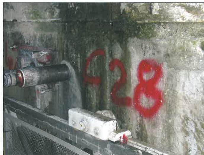
Figura 3 - Le fasi di prelievo delle carote
