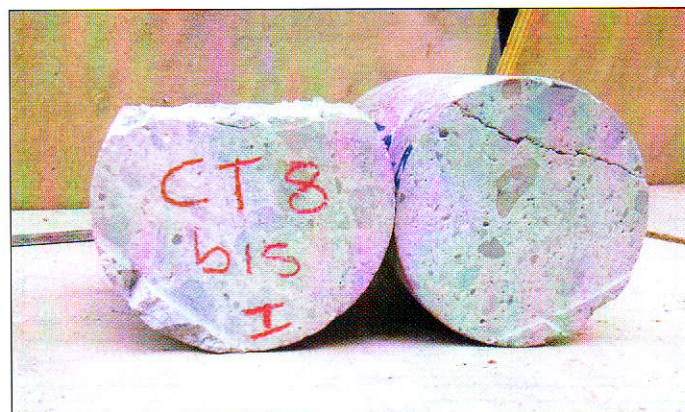
Figura 3 - La lesione longitudinale su una carota prelevata dall'anima di una trave
