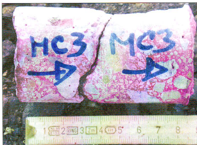
Figura 2 - Carota prelevata da una trave esposta alla fiamma
