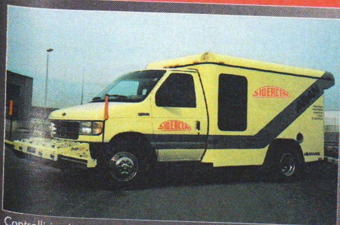
Controlli in situ su pavimentazioni stradali: sistema ARAN
