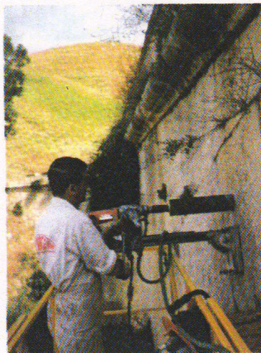
Prelievo di conglomerato cementizio mediante carotaggio (Uni 6131) sulla s.p. 103 nella provincia di Caltanissetta
