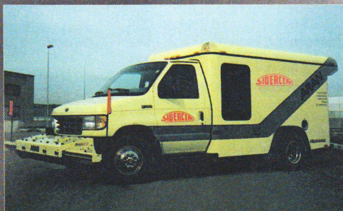
Controlli in situ su pavimentazioni stradali: sistema ARAN
